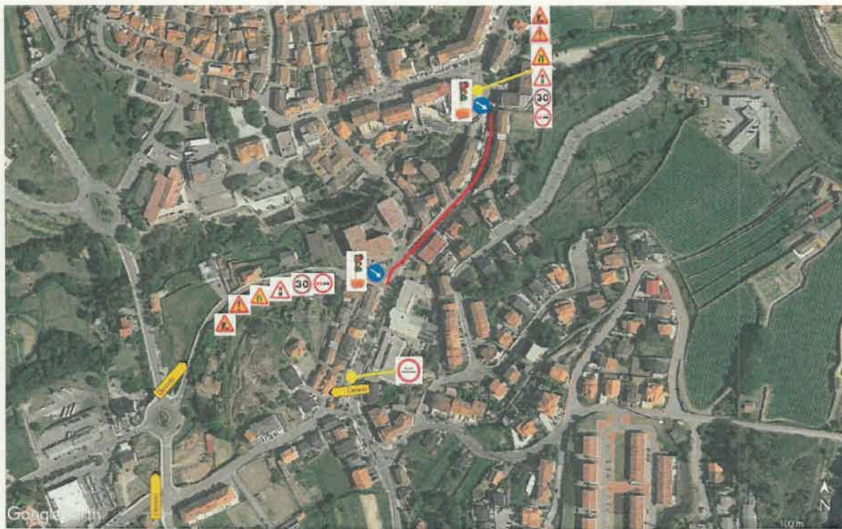
Anexo XXVII – N202 – Circulação alternada (Início dos trabalhos 21/04/2023 até 27/04/2023)
