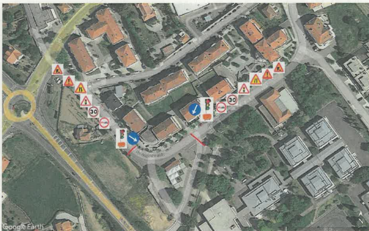
Anexo XXVI – N202 acesso Avenida Salgueiro Maia – Circulação alternada (Início dos trabalhos 21/04/2023 até 27/04/2023)
